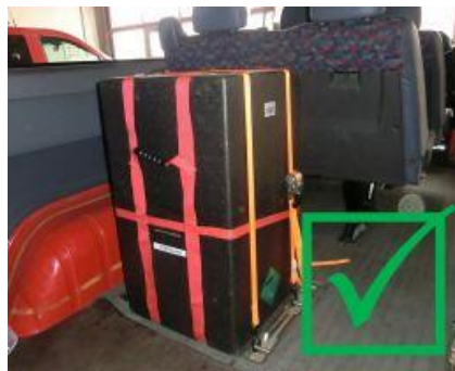
Positivbeispiel: Gesicherter Transportbehälter (Foto: Detlef Garz, FUK Mitte)
